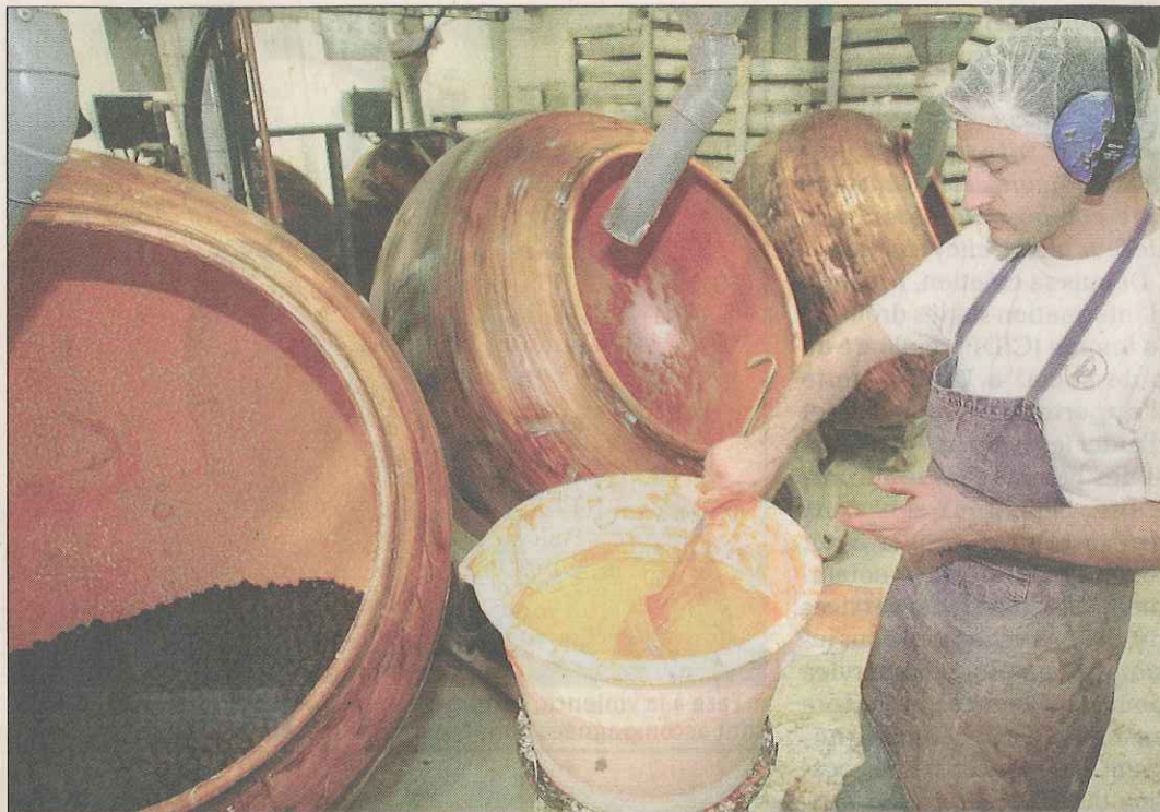
La salle d'enrobage où tournent d'immenses toupies de cuivre qui serviront à fabriquer, par couches successives, quelques unes des douceurs de Doucet.
